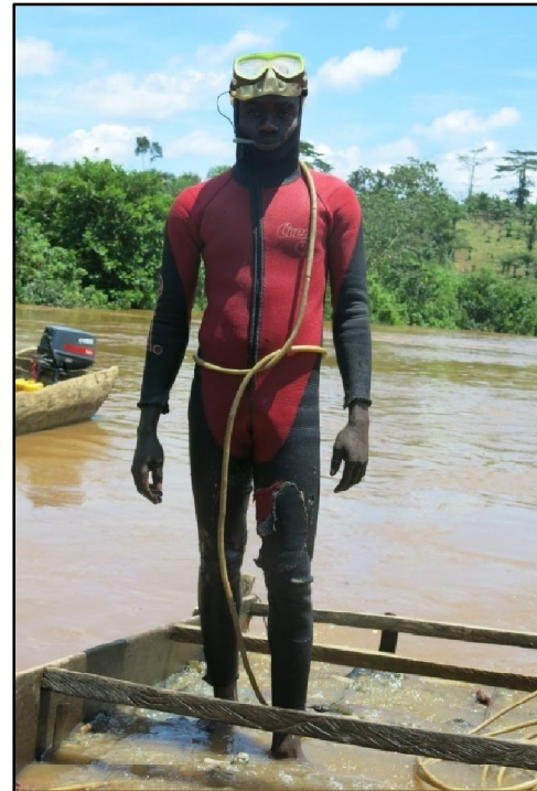
Fig. 8 Plongeur disposant d'un masque de plongeur, d'une combinaison néoprène, ainsi que d'un tuyau qui lui procure de l'oxygène moyennant un compresseur. Il plonge dans une profondeur de 4 à 12 m.
